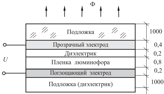
Рис. 4.20. Структура тонкопленочного ЭЛИ
