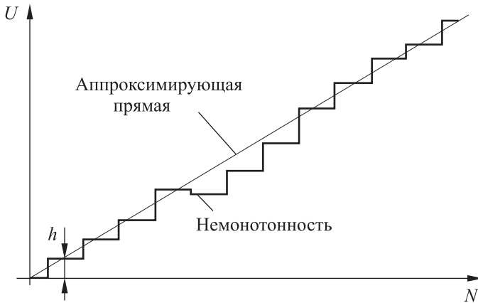
Рис. 5.13. Передаточные характеристики ЦАП при наличии дифференциальной нелинейности
