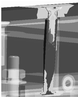
Рис. 1 – Контакт «винт М3х12 – пластина корпуса» на резонансной частоте 30,1 Гц
