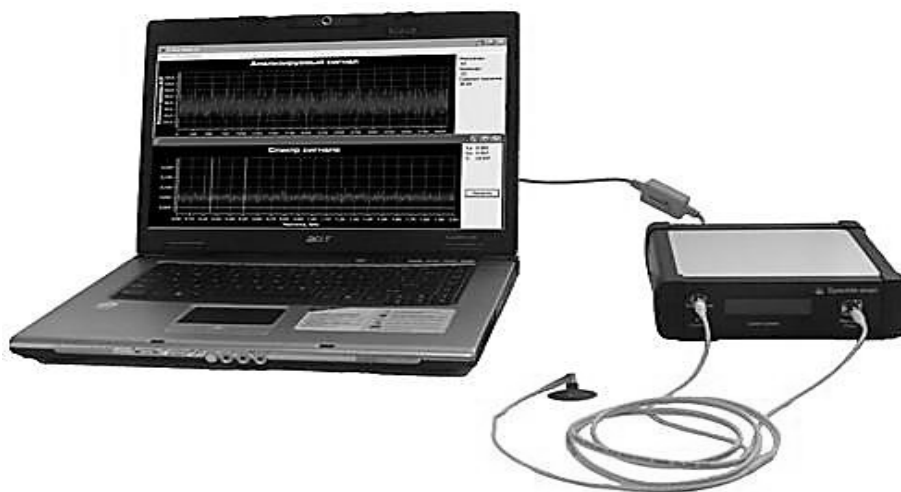
Рис.1 – Макетный образец лазерной спекл-оптической системы контроля микроциркуляции крови для неинвазивной оценки состояния поверхностной микрогемодинамики
