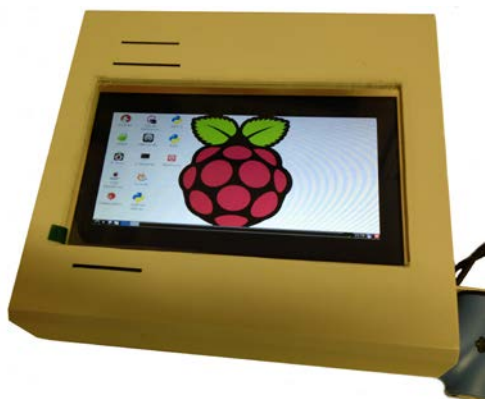
Рис.1. – Устройство контроля на базе миникомпьютера Raspberry PI
