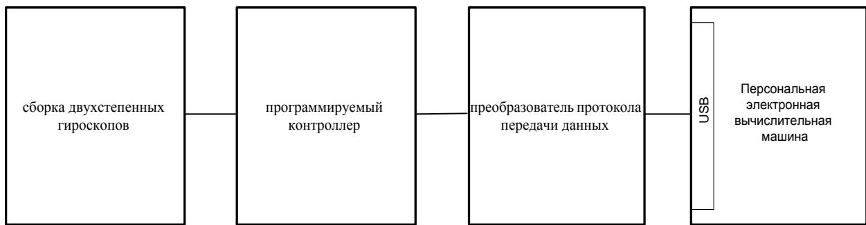
Рис. 1 Структурная схема «Демонстрационный макет двухстепенного гироскопа с индикацией работы на ПЭВМ»
