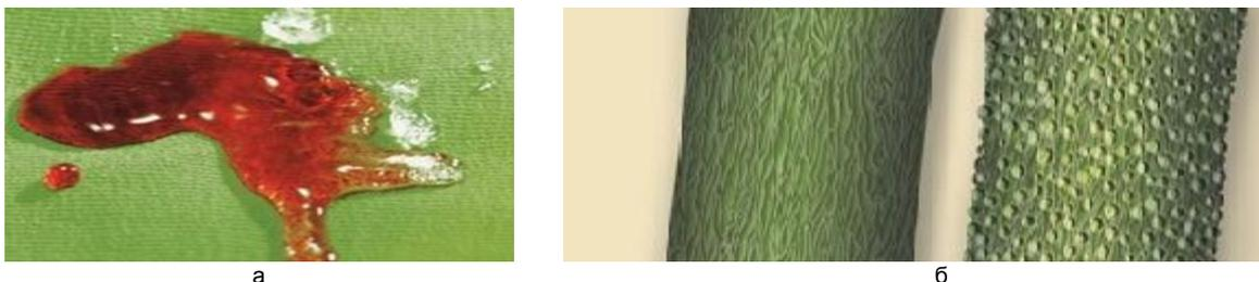
Рис. 3 – Ткань, которая "сбрасывает" воду и другие пищевые жидкости: а – свойство супергидрофобности, б – необработанное хлопковое волокно (слева), обработанное хлопковое волокно (справа)
