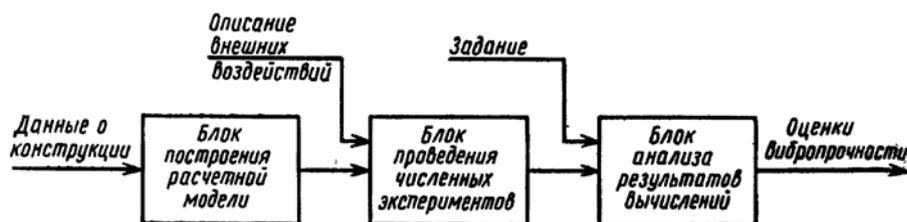
Рис. 1 – Блок-схема имитационной модели
