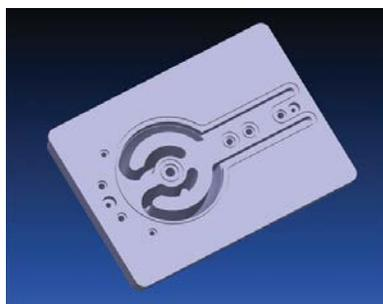
Рис. 4 – Каналы охлаждения вставки пуансона
