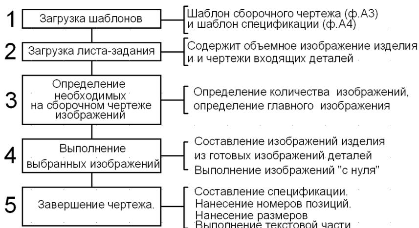
Рис. 1. Этапы выполнения электронного сборочного чертежа
