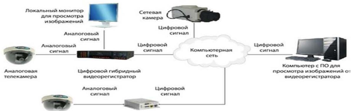
Рисунок 1 – Структурная схема видеонаблюдения
