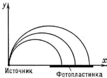
Рисунок 1- Траектория электронов в поперечном магнитном поле
