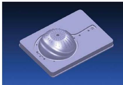
Рис. 3 – Модель вставки пуансона
