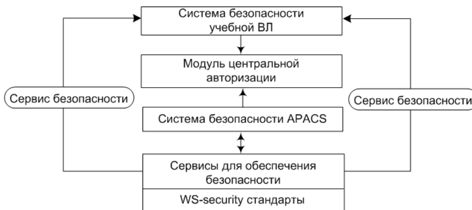
Рис. 2 – Схема организации безопасности для системы APACS с интегрированной ВЛ
