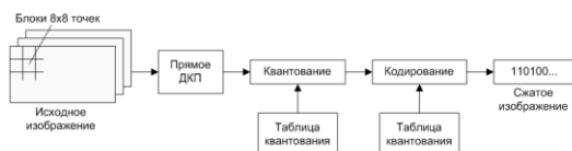
Рис. 1 – Общая схема алгоритма сжатия JPEG
