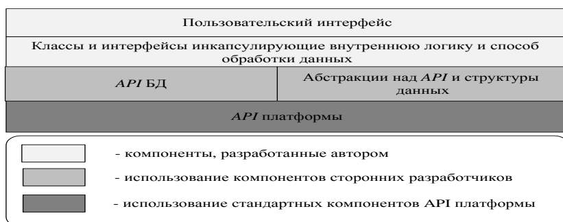
Рис. 1 - Обобщенная структура программного обеспечения компьютерного тренажера систем тропосферной связи
