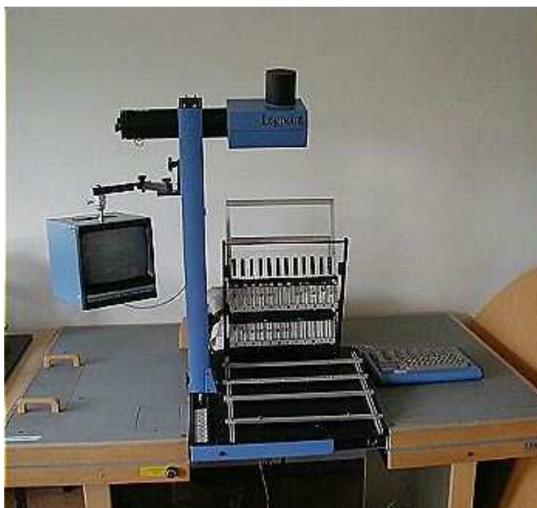
Рис. 6.3. Светомонтажный стол с гибкой программой сборки
