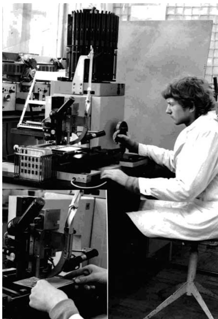
Рис. 6.5. Установка ИМС на полуавтомате с пантографом
