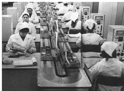
Рис .7.9. Двустороннее расположение рабочих мест в "шахматном порядке": 1 - натяжная станция, 2 - конвейер, 3 - рабочие места, 4 - приводная станция.
