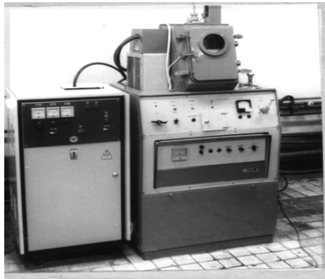
Рис. 2.5. УЗ установка получения порошков припоев
