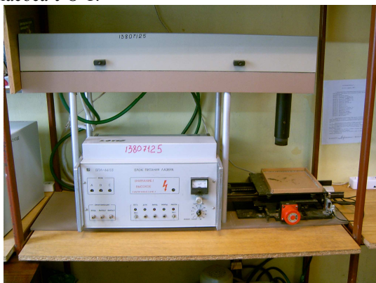
Рис. 10.28. Лазерная установка для исследований процесса пайки
