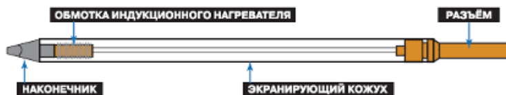
Рис. 9.28. Схема индукционного паяльника
