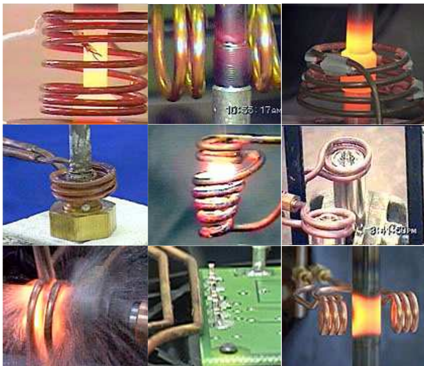
Рис. 9.32. Применение ВЧ нагрева для конструкционной и монтажной пайки
