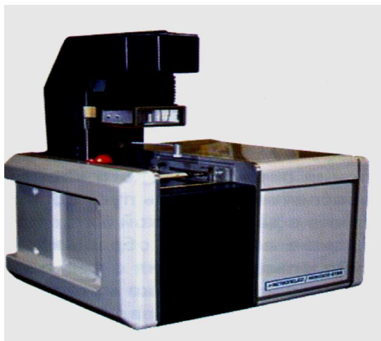
Рис. 3.15. Тестер контроля паяемости Menisco ST88
