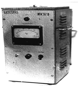
Рис. 8.36. УЗ ванна лужения труднопаяемых металлов
