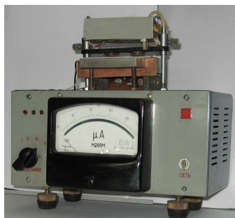
Рис. 3.10. Схема (а) и внешний вид (б) прибора оценки паяемости покрытий
