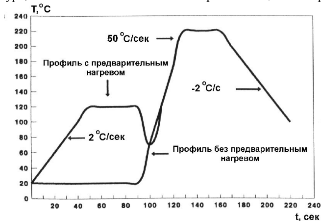
Рис.7.26. Температурно-временной профиль процесса пайки в парогазовой фазе
