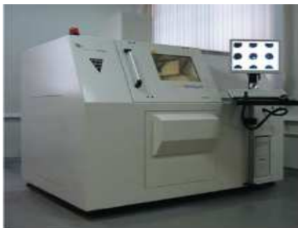
Рис. 13.9. Нанофокусная система рентгеновского контроля
