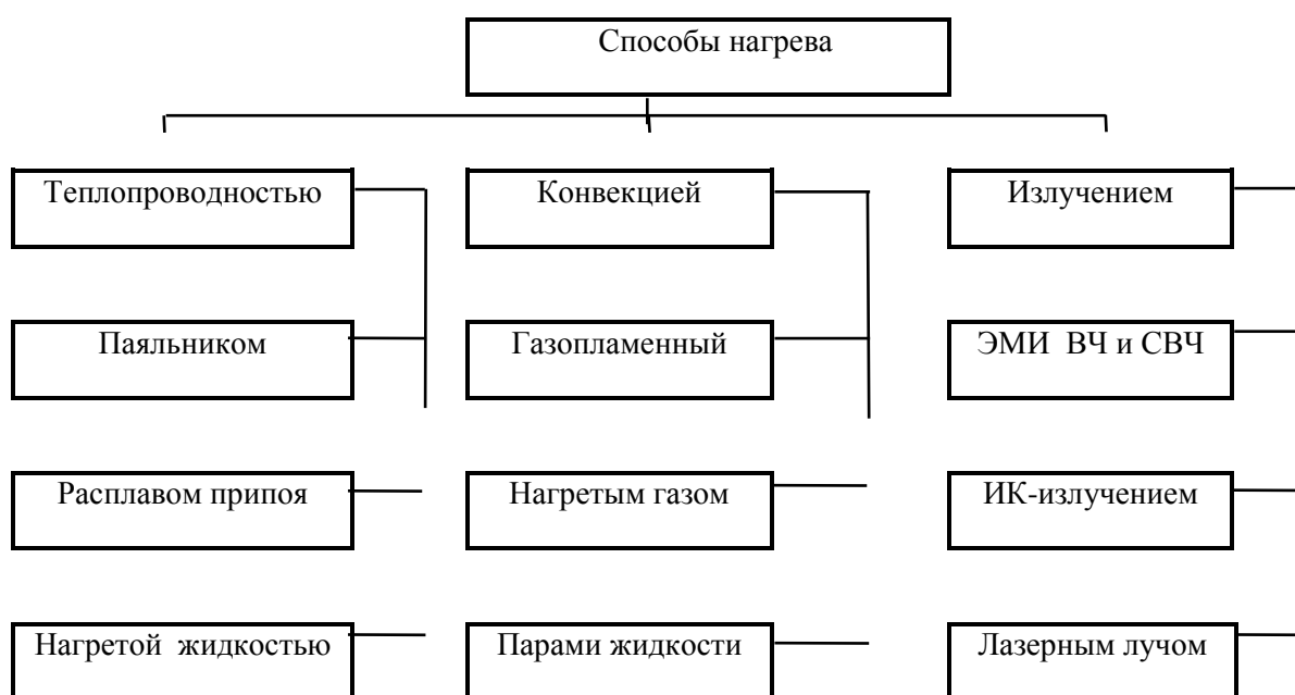
Рис. 1.2. Классификация способов нагрева при пайке
