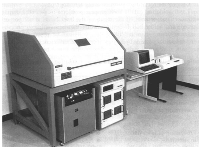
Рис. 3.2. Установка лазерной пайки с программным управлением
