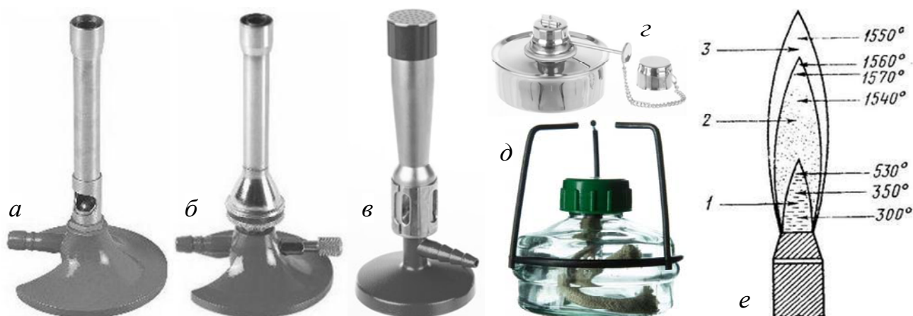
Рис. 8. Газовые горелки Бунзена (а), Теклю (б), Мекера – Фишера (в) и спиртовые горелки (г и д). Строение пламени горелки (е)
