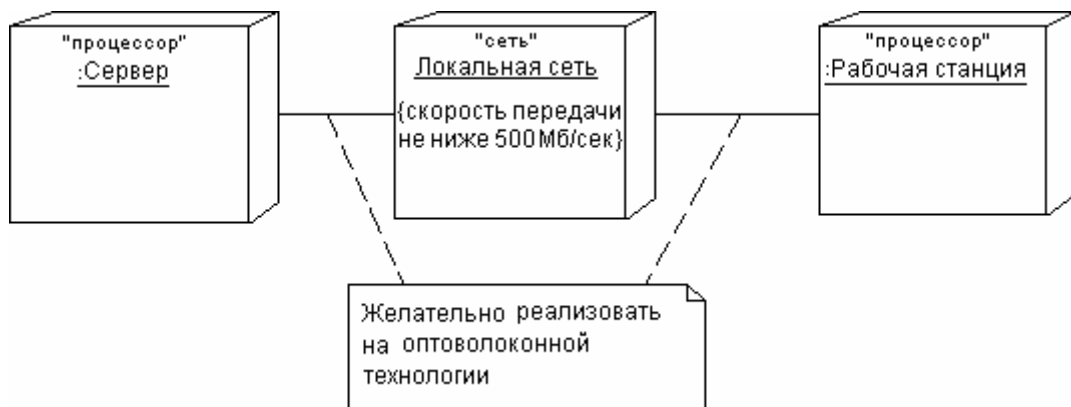
Рис. 70 Фрагмент диаграммы развертывания с соединениями между узлами
