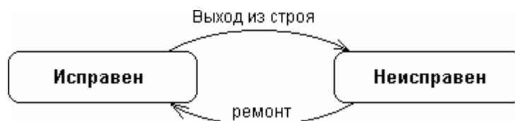
Рис. 53 Простейший пример диаграммы состояний для технического устройства типа компьютер
