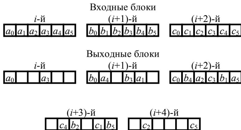
Рис. 5.3. Пример межблокового перемежения при  $B=3$  и  $N=2$
