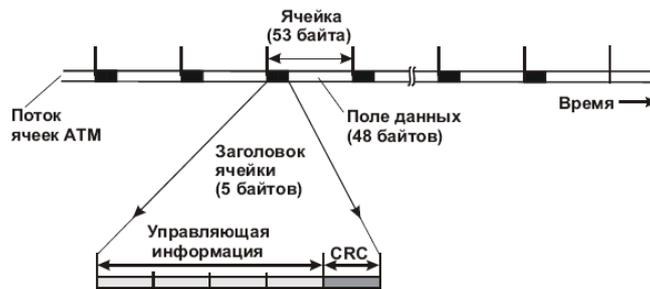
Рис. 9.42. Непосредственная передача ячеек ATM по линии связи
