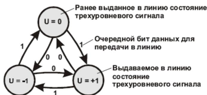
Рис. 3.5. Диаграмма состояний передатчика
