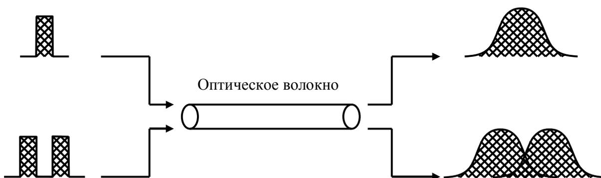
Рис. 4.6. Расширение импульсов
