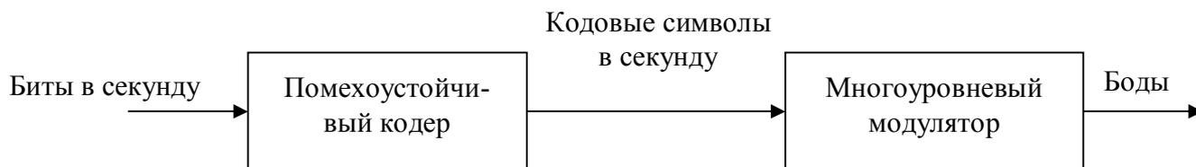
Рис. 4.31. Пример системы передачи, требующей для своего описания различные единицы скорости передачи
