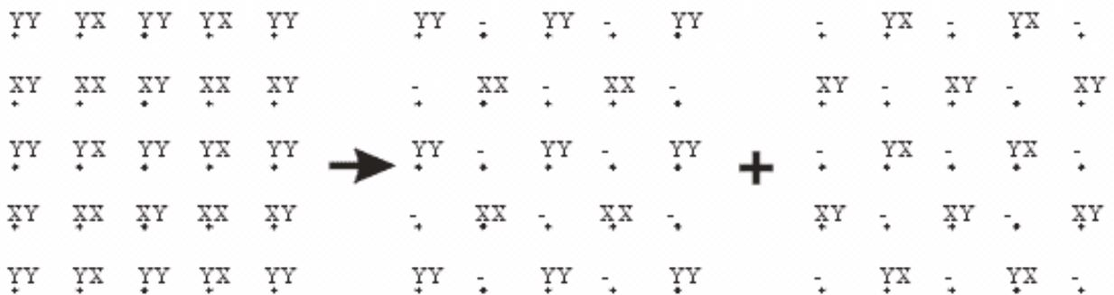
Рис. 1.55. Разделение исходного созвездия на два подсозвездия приводит к увеличению минимального расстояния между сигнальными точками
