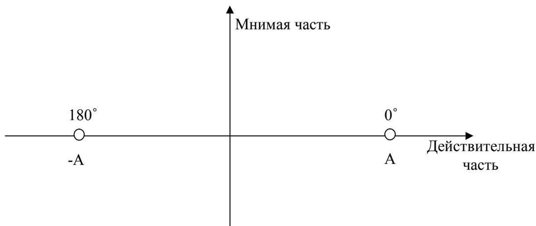
Рис. 1.2. Сигнальное созвездие ФМ-2 сигнала
