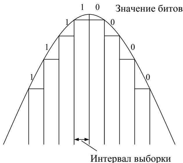
Рис. 4.19. Кодирование речи с помощью технологии *CVSO*
