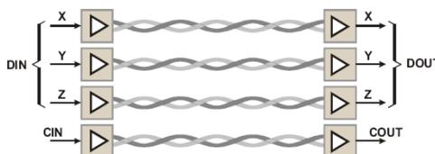
Рис. 3.18. Схема параллельной передачи данных и синхросигнала по витым парам проводов без применения кодирования
