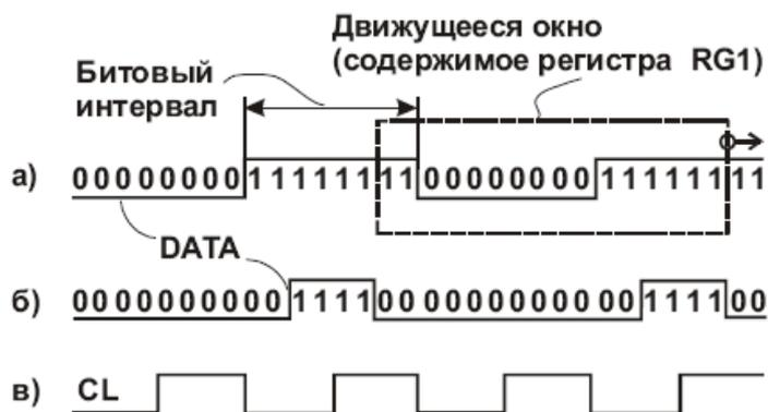
Рис. 9.24. Временные диаграммы, поясняющие принцип действия коррелятора:
