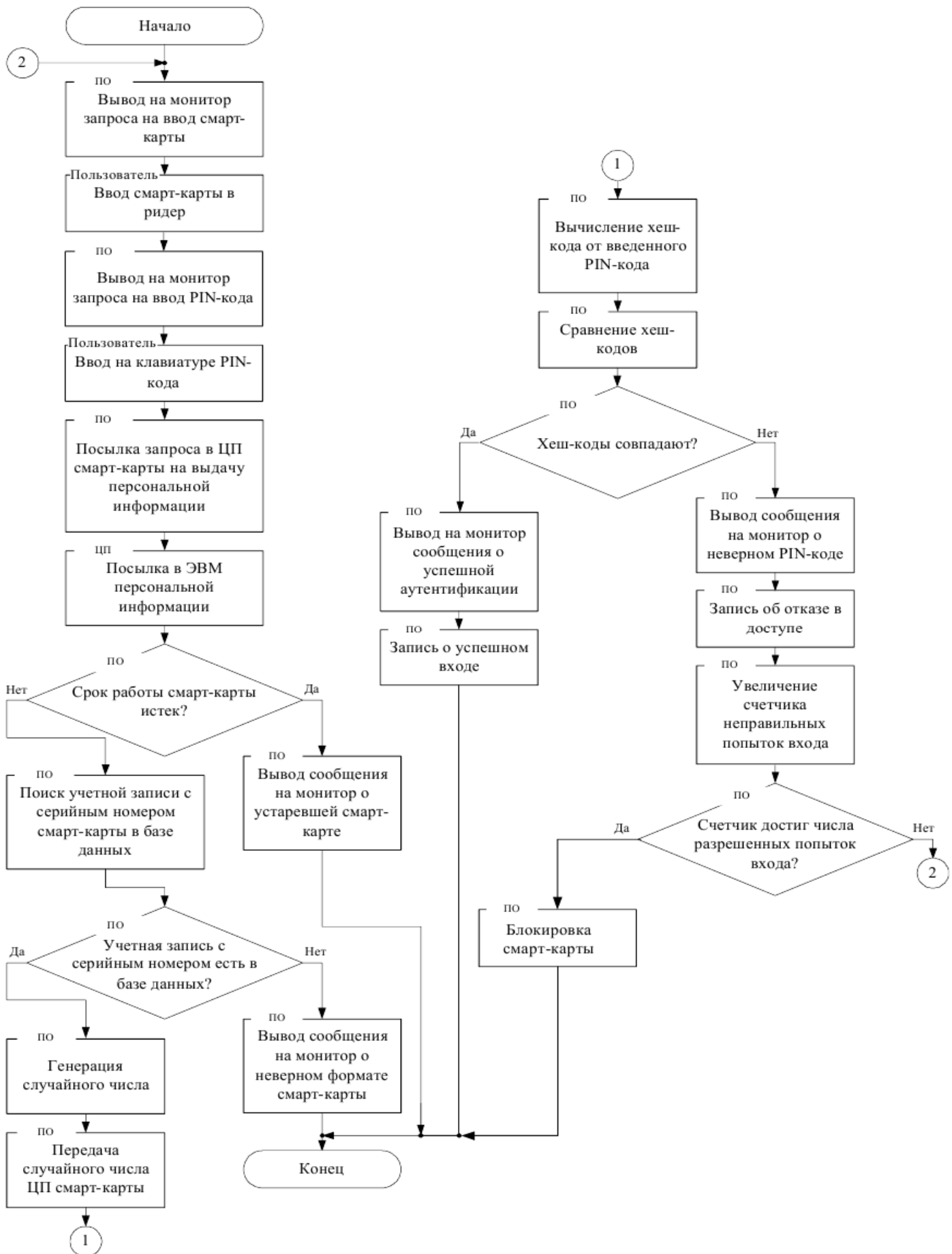
Рисунок 10.5 - Схема алгоритма функционирования средства аутентификации с использованием смарт-карт
