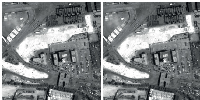
Рисунок 1 – Пример изображения с импульсным шумом (слева) и результат его фильтрации(справа)
