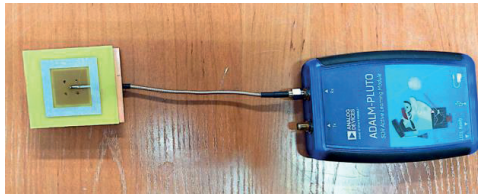
Рисунок 1 – ADALM Pluto с патч-антенной WI-Fi
