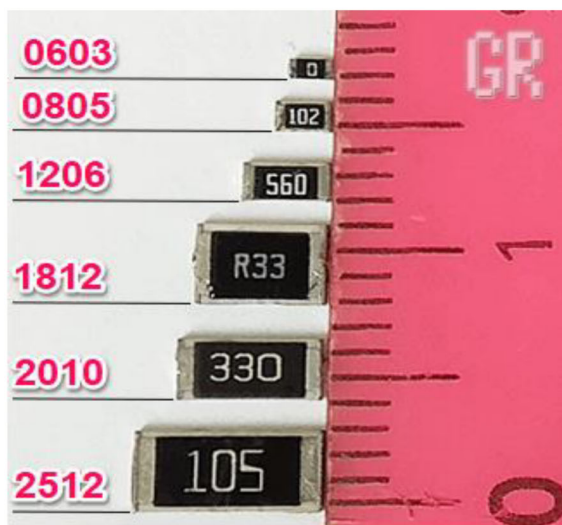
Рисунок 3.5 – Соответствие кода типоразмера SMD -резисторов размеру в миллиметрах
