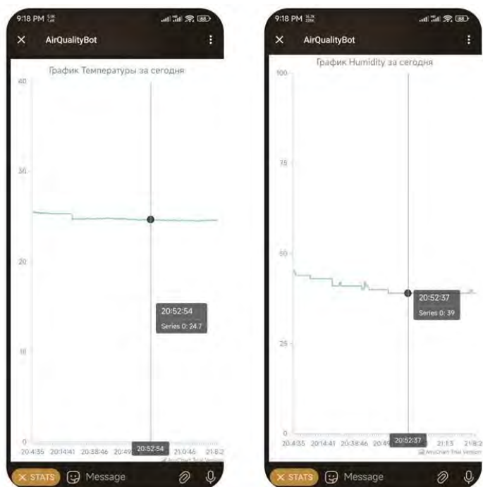
Рисунок 4. Отображение сведений с датчиков устройства о температуре и влажности в производственном помещении
