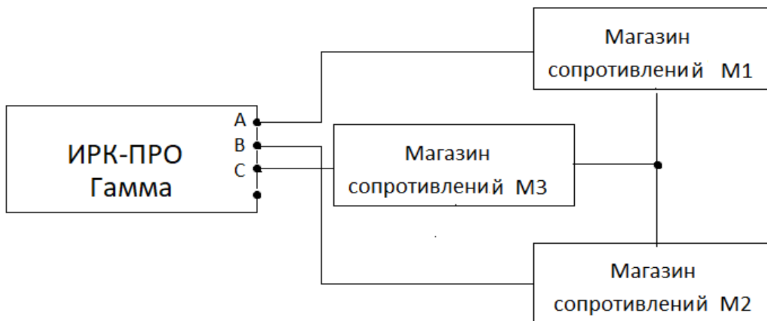
Рисунок 2 – Схема соединения приборов при определении абсолютной погрешности определения расстояния до места повреждения изоляции кабеля
