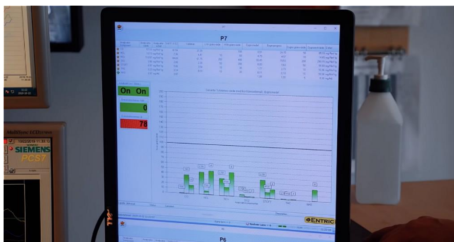
Рисунок 4 – Система контроля доли вредных веществ в реальном времени.
