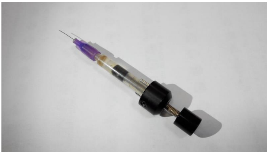
Рисунок 1 – Шприц-дозатор, формирующий капли объемом 2,5 мкл
