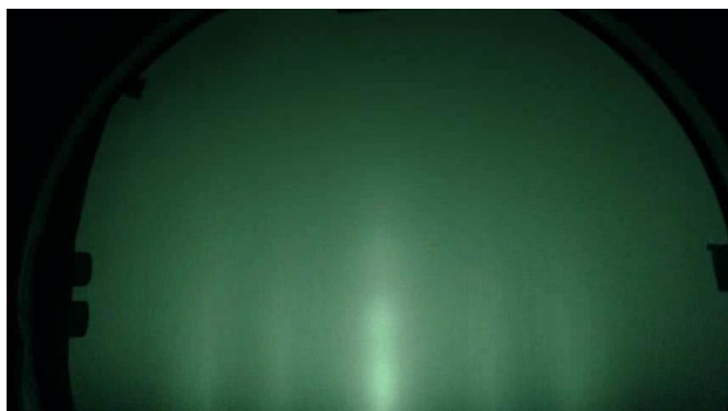
Рисунок 1 – Типичная дифрактограмма графена полученная методом RHEED
