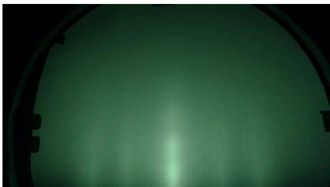
Рисунок 1 – Типичная дифрактограмма графена полученная методом RHEED
