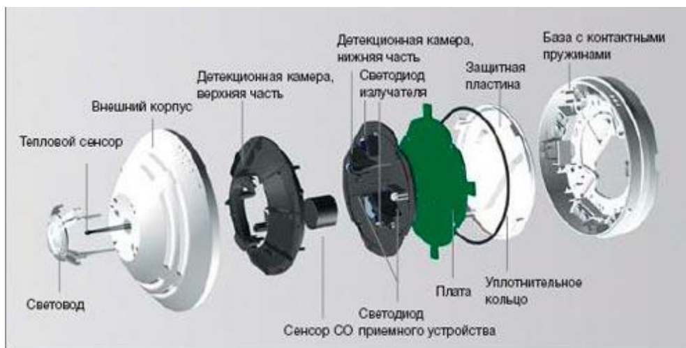
Рис. 2.15. Конструкция комбинированного пожарного извещателя
