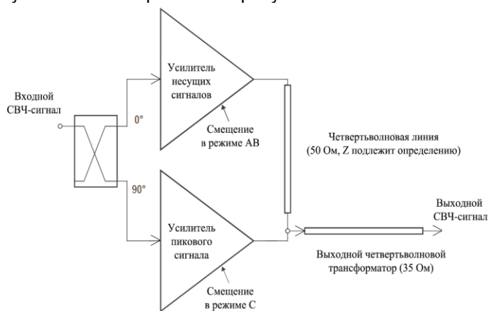
Рисунок 1 – Схема усилителя мощности по методу Догерти
