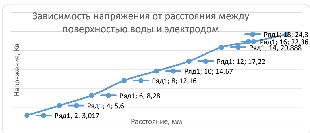
Рисунок 3 – Зависимость напряжения зажигания плазмы от расстояния между электродами
