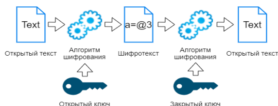
Рисунок 1 – Структурная схема работы асимметричных криптосистем
