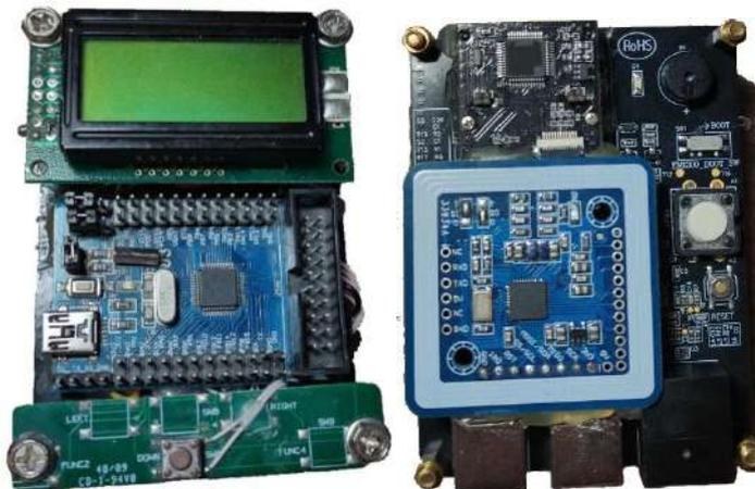
Рисунок 2 – Вид портативного сканера сверху и снизу
