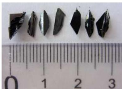
Рисунок 1 – Монокристаллы соединения  $\text{Cu}_2\text{ZnGeS}_4$
