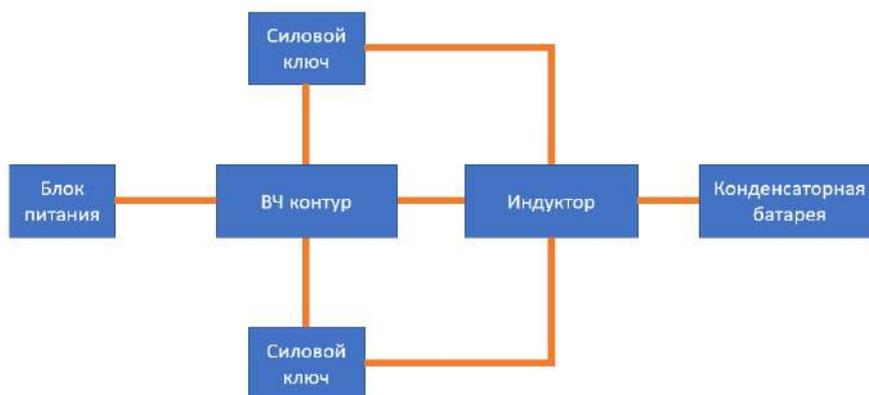
Рисунок 1 – Структурная схема ZVS генератора
