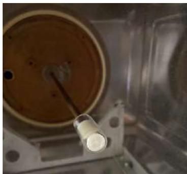
Рисунок 4 –Активный зонд, размещенный в СВЧ разрядной камере
