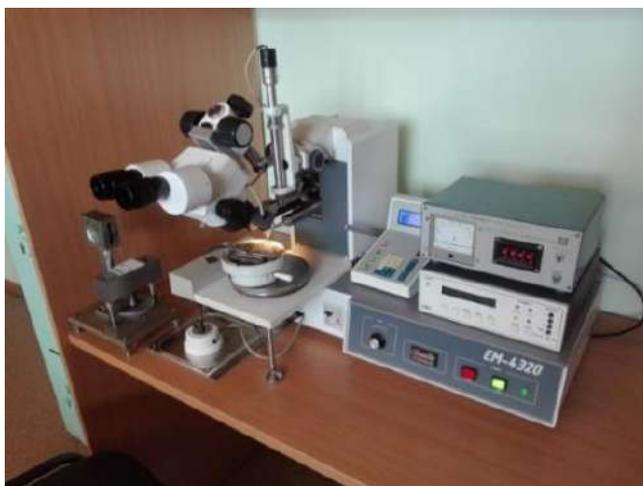
Рисунок 4 – Установка присоединения выводов ЭМ-4320
