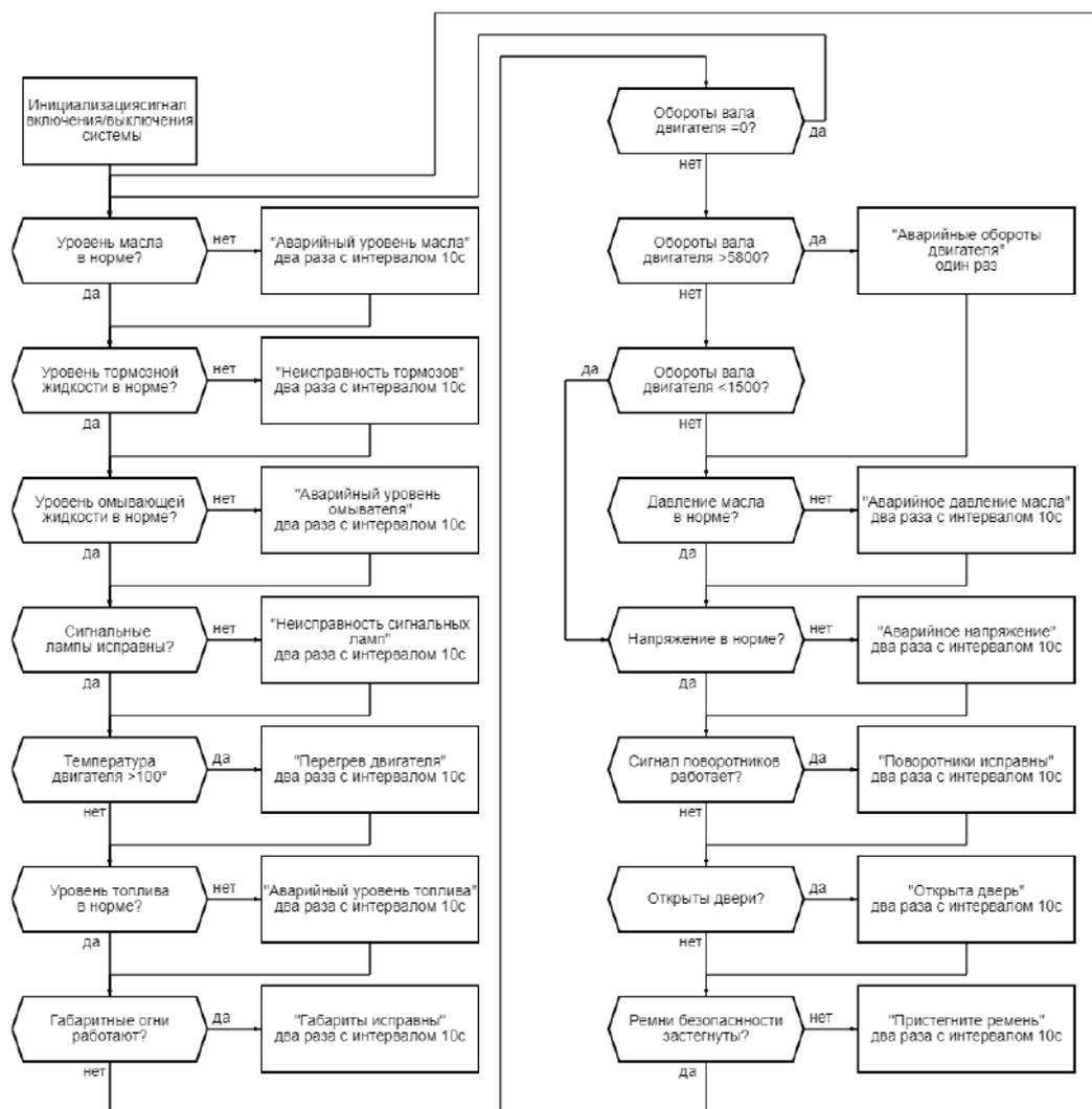
Рисунок 1 – Функциональный алгоритм работы устройства
