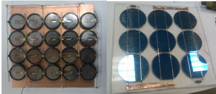
Рис. 3 - Основные элементы лабораторного макета, батарея суперконденсаторов (слева) и фотоэлектрический преобразователь (справа)
