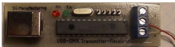
Рис. 3 – USB – DMX переходник
