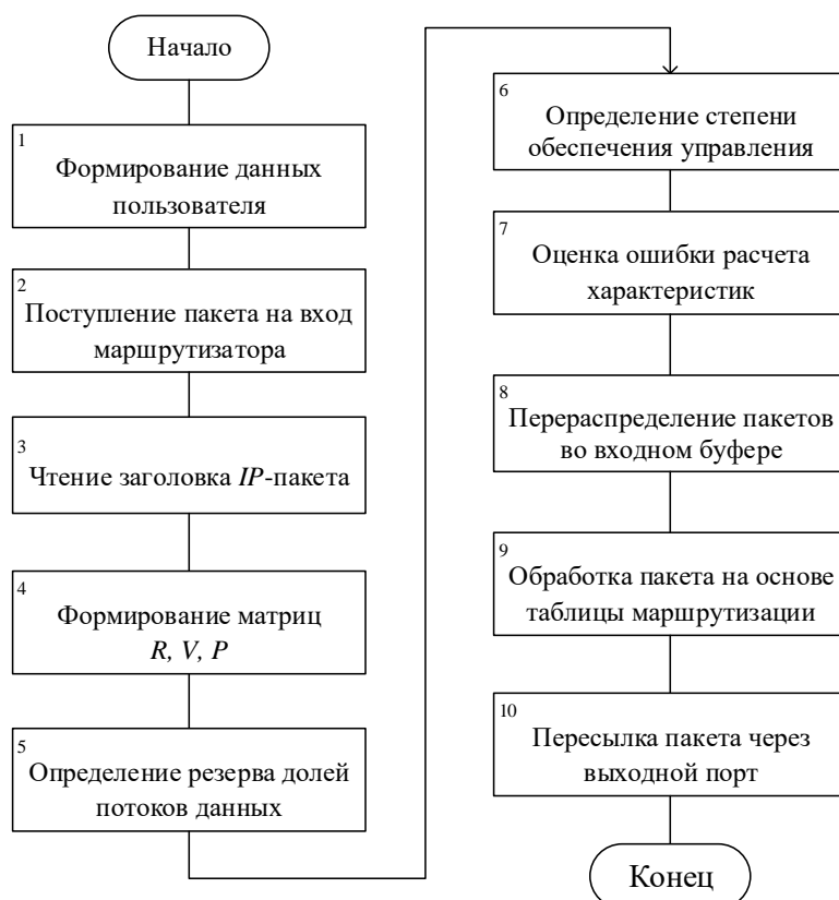
Рисунок 3. – Алгоритм приоритетного управления неоднородными данными буферных накопителей маршрутизаторов
