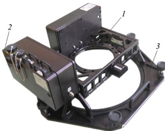
1 – ПН; 2 – БЭ СОВА; 3 – основание для крепления ПН к иллюминатору
