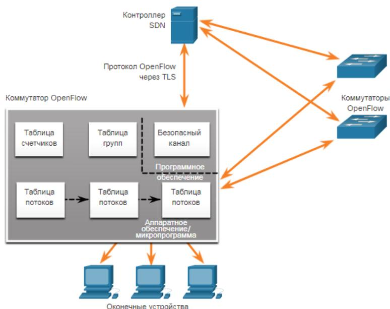
Рисунок 2 – Принцип функционирования сети SDN на базе протокола OpenFlow
