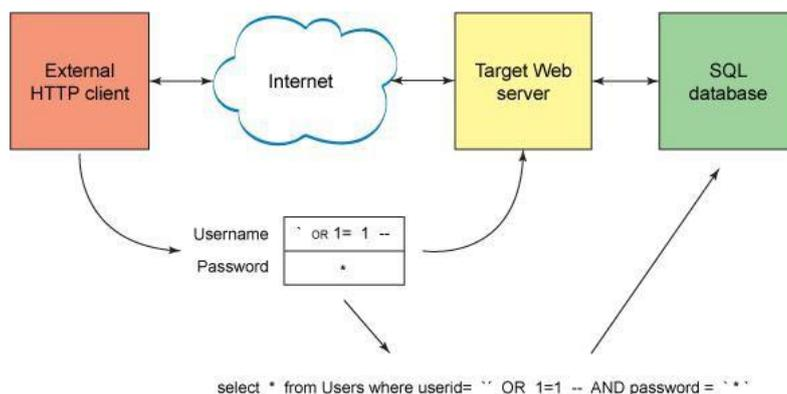
Рисунок 2 – Схема принципа действия SQL инъекций
