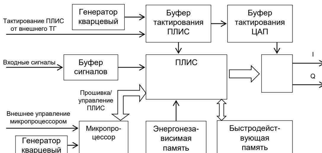
Рисунок 2 – Структурная схема модуля имитатора цели
