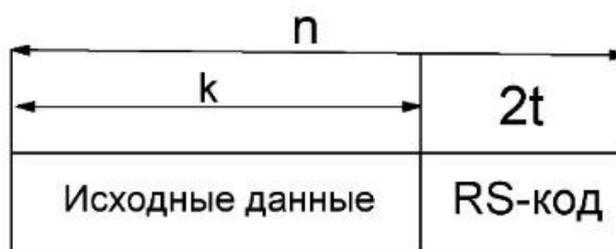
Рисунок 3 – Структурная схема пакета данных
