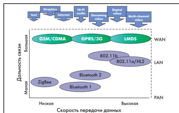
Рис. 2 – Позиционирование в ряду беспроводной передачи данных
