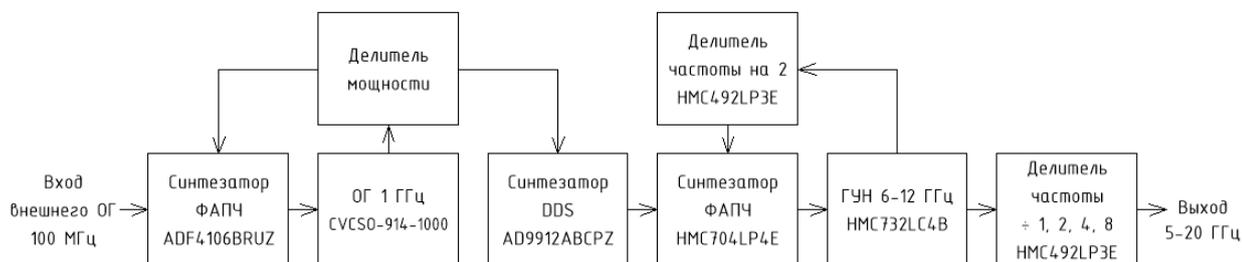
Рисунок 2 - Структурная схема синтезатора частоты 5 – 20 ГГц
