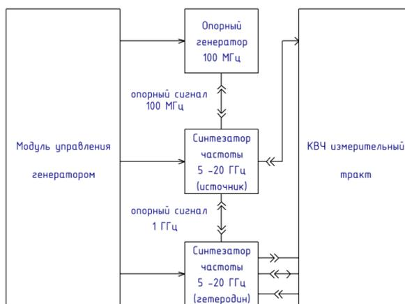
Рисунок 3 – Структурная схема векторного анализатора цепей после модернизации
