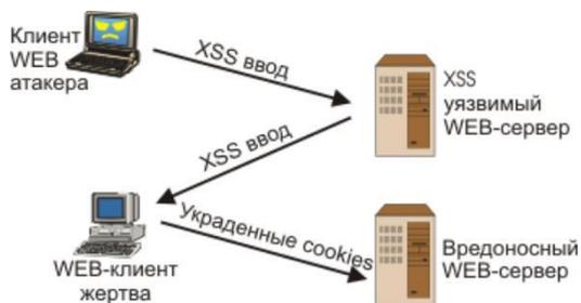
Рисунок 3 – Схема принципа действия межсайтового скриптинга
