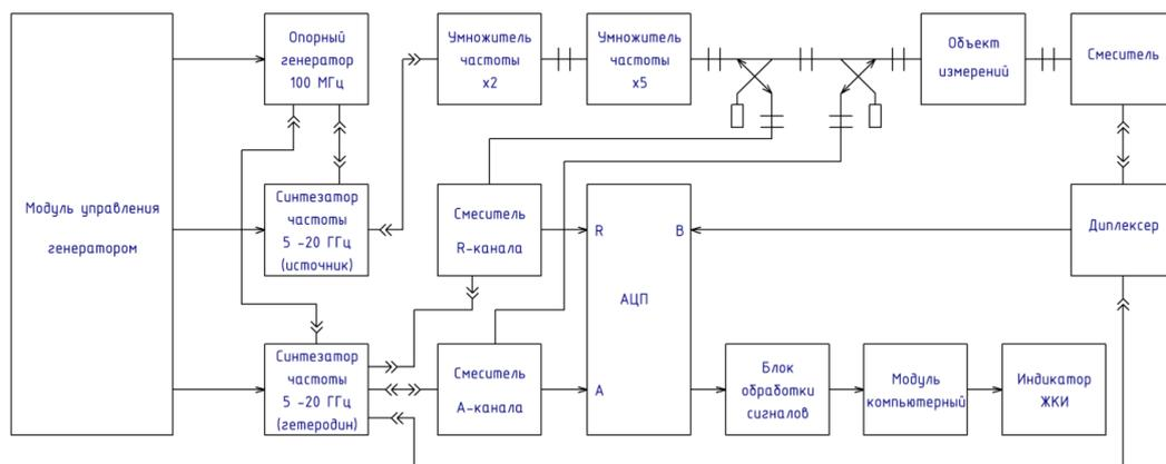
Рисунок 1 – Структурная схема векторного анализатора цепей
