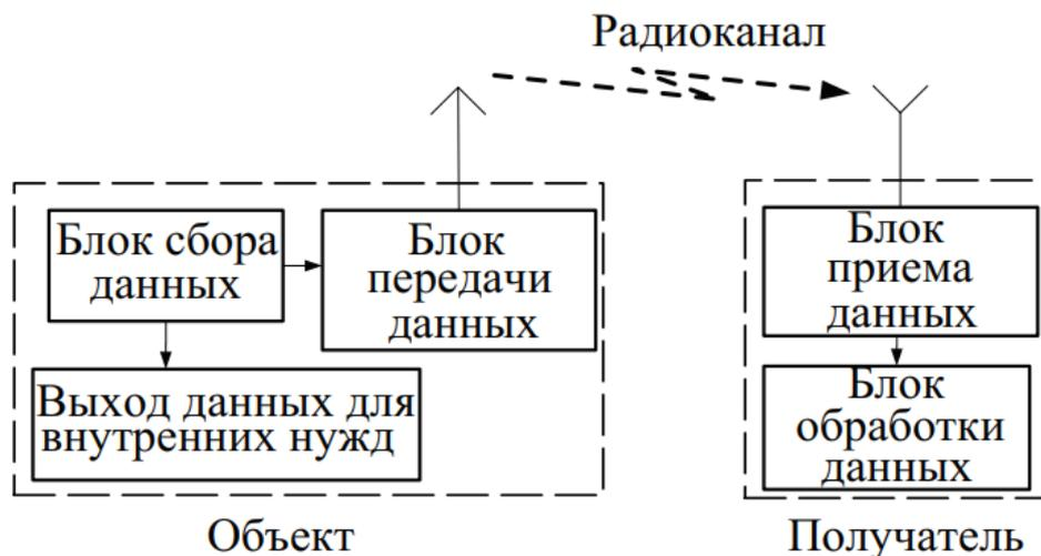
Рисунок 1 – Обобщенная структурная схема телеметрической системы
