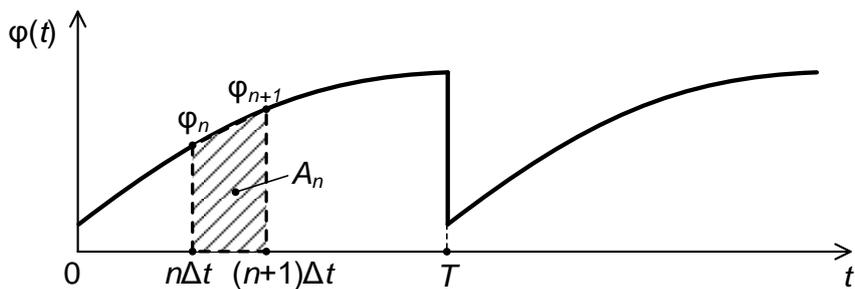
Рисунок 1 – Аппроксимация входного воздействия методом трапеций
