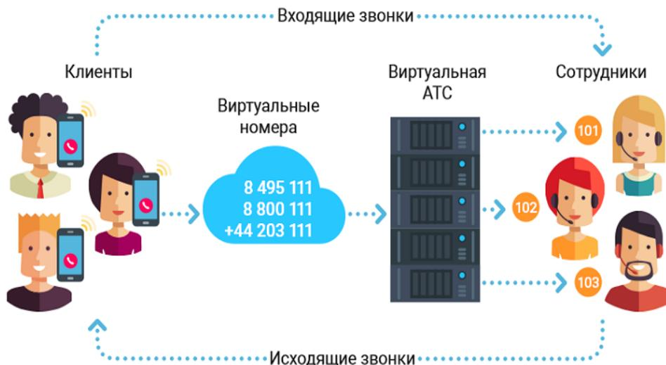
Рисунок 2 – Схема работы виртуального номера
