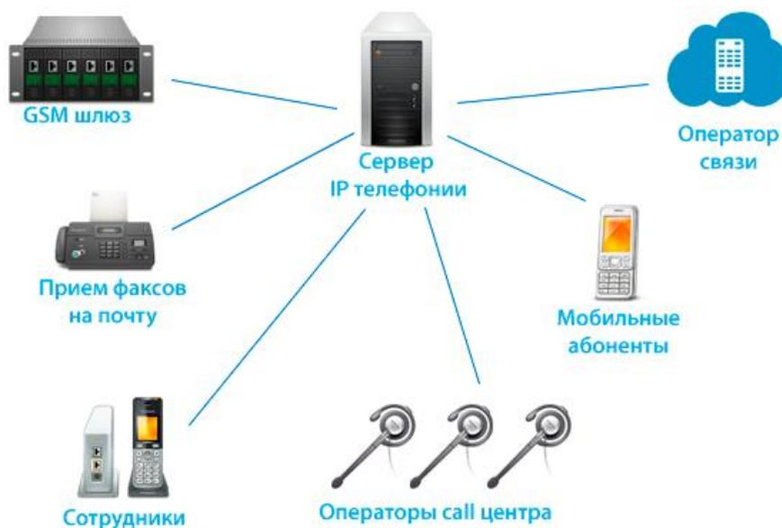
Рисунок 1 – Схема организации IP-телефонии
