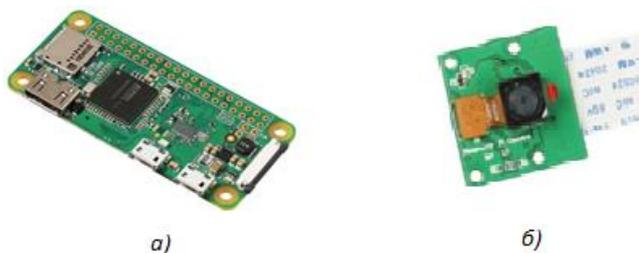
Рисунок 1 - Модули камеры: а) Raspberry Pi Zero W, б) Raspberry Pi Camera Rev 1.3
