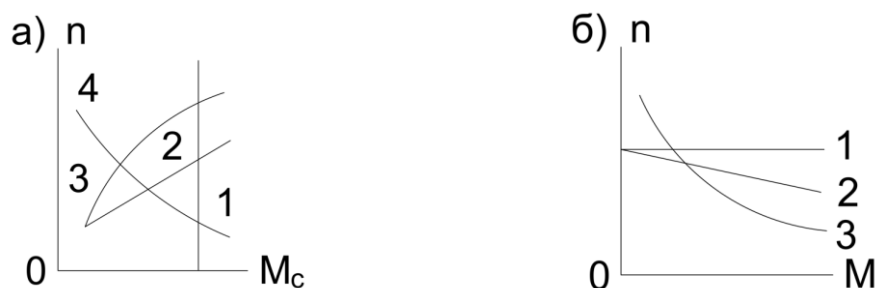
Рис. 1.2. Механические характеристики: а) производственных механизмов; б) электродвигателей. 1-4 – механические характеристики.
