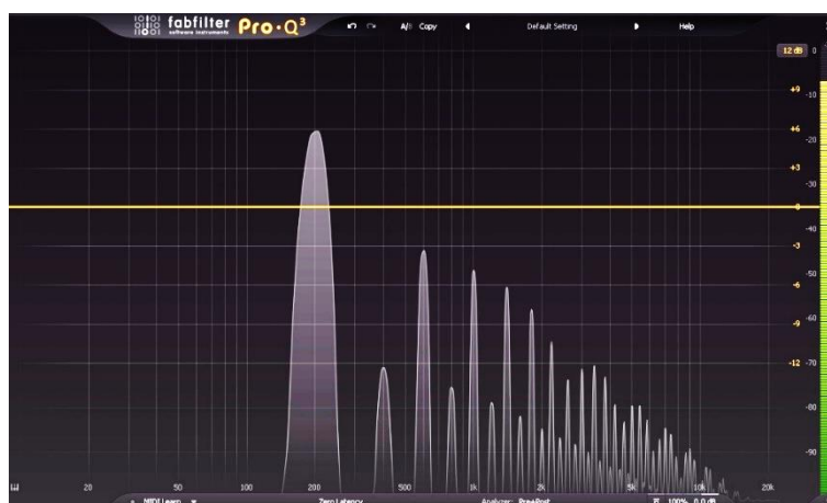
Рис. 6. Спектр синусоидного сигнала, обработанного Comp FET-76
