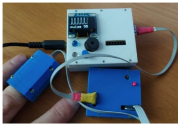
Рис. 2. Два варианта датчика пульса: a – Easy Pulse; b – Pulse Sensor
