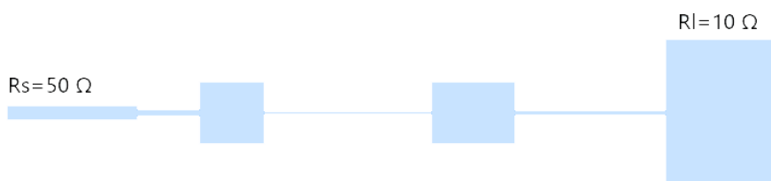
Рисунок 2 – Структура 1 топологии ступенчатого трансформирующего фильтра диапазона СВЧ
