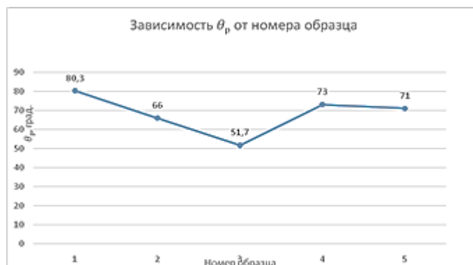
Рисунок 1 – Зависимость среднего по растворам краевого угла смачивания от образца макropористого кремния
