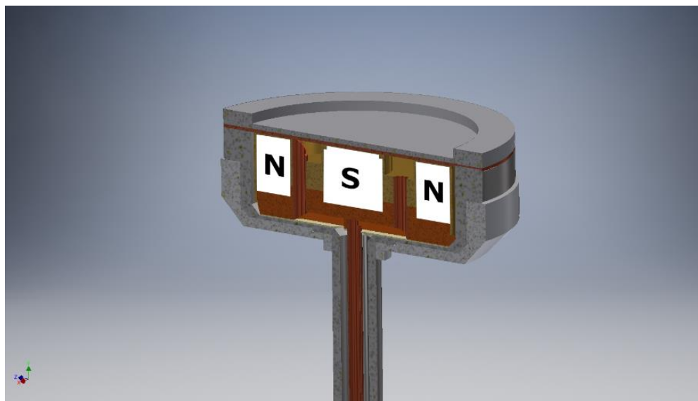
Рисунок 1 – Геометрическая модель МРУ с обозначенными полюсами магнитной системы
