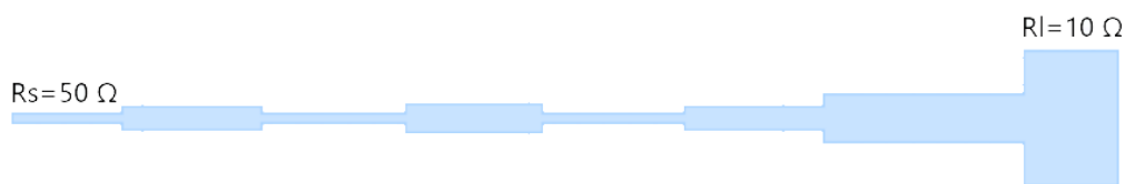
Рисунок 3 – Структура 2 топологии ступенчатого трансформирующего фильтра диапазона СВЧ
