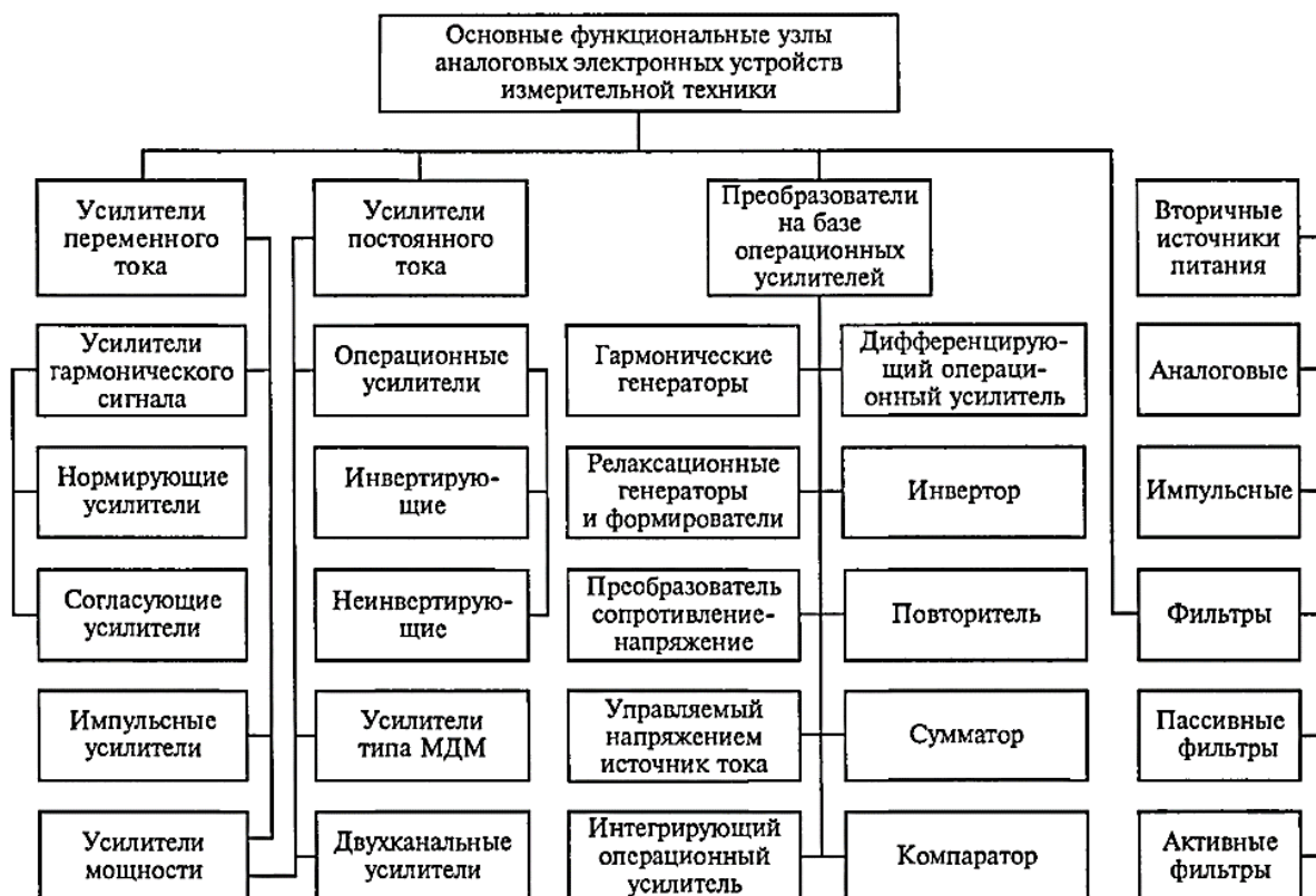
Рисунок 1 – Перечень основных функциональных узлов устройств измерительной техники
