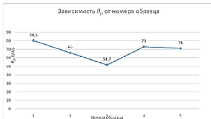
Рисунок 1 – Зависимость среднего по растворам краевого угла смачивания от образца макropористого кремния
