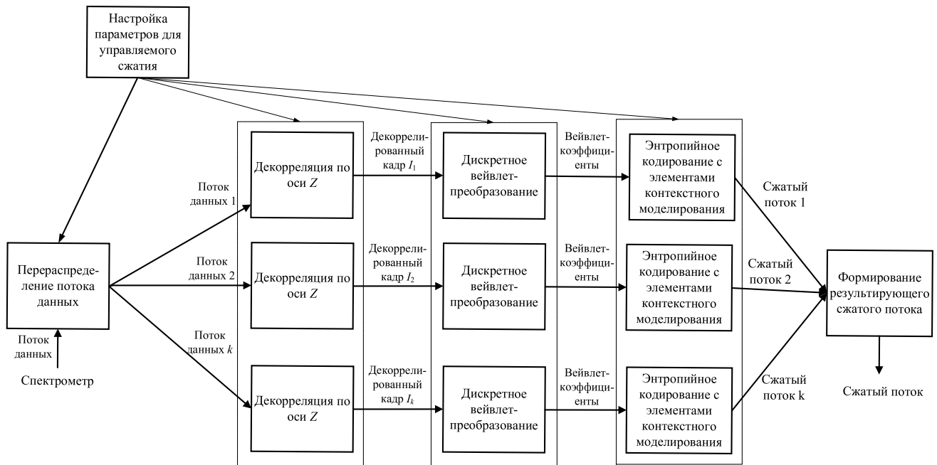
Рисунок 3. – Общая схема работы блочно-субполосного вложенного алгоритма сжатия
