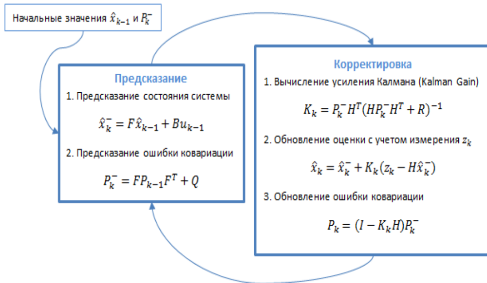
Рисунок 1 – Алгоритм работы фильтра Калмана
