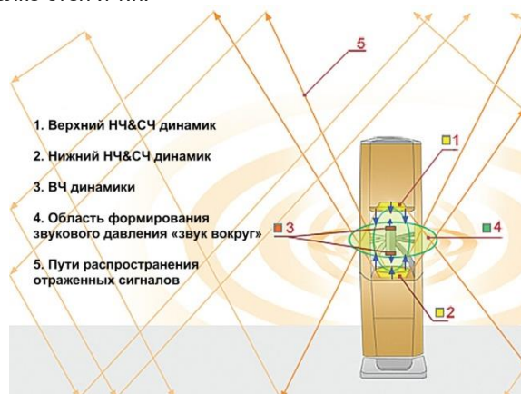
Рисунок 5 – Структура контрапертурной АС и распространение сигналов
