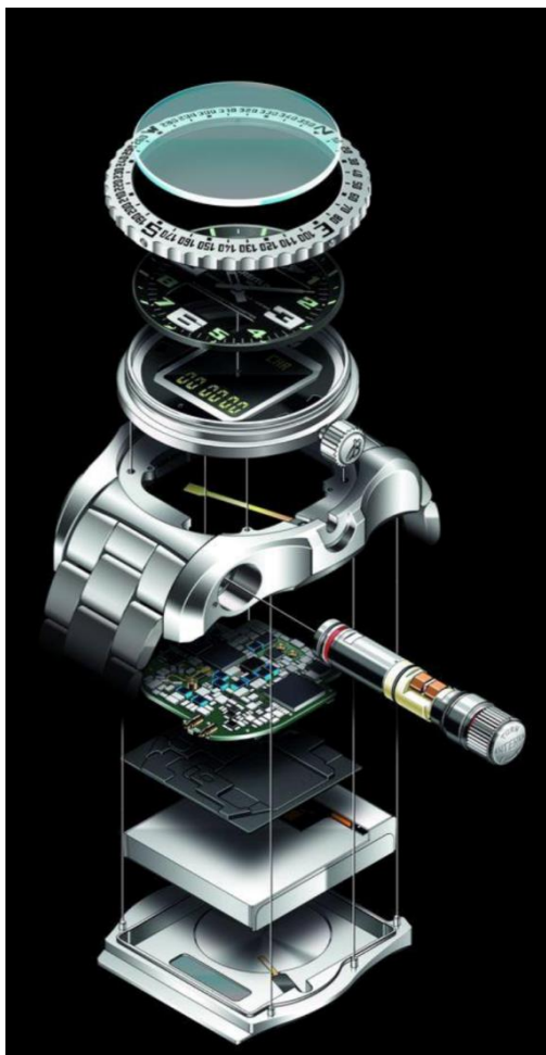
Рисунок 2 – Модель устройства со встроенным персональным радиомаяком
