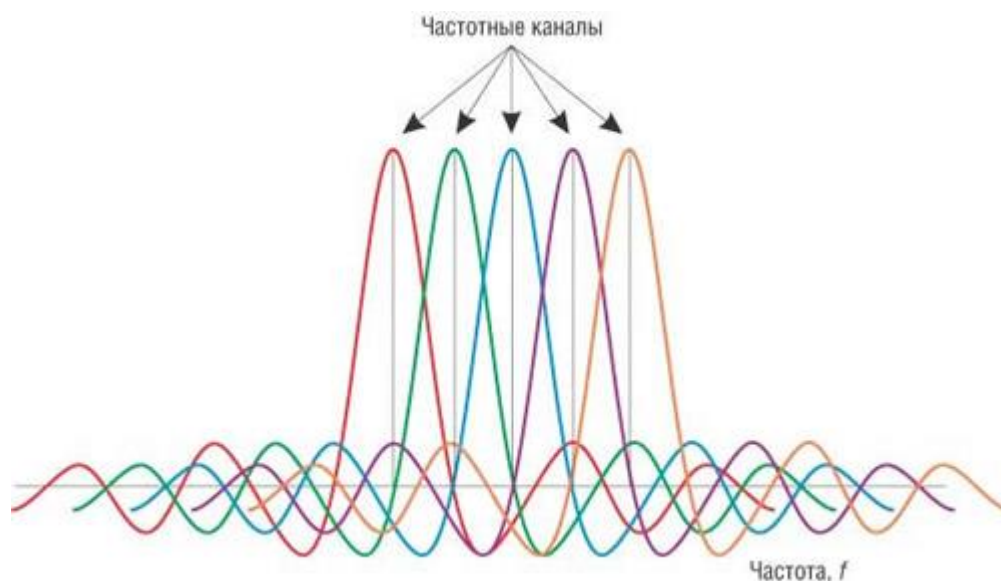
Рисунок 2– Разделение частотных каналов при OFDM
