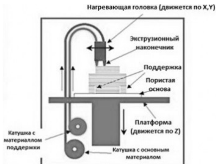
Рисунок 1 – Схема работы типичного FDM принтера
