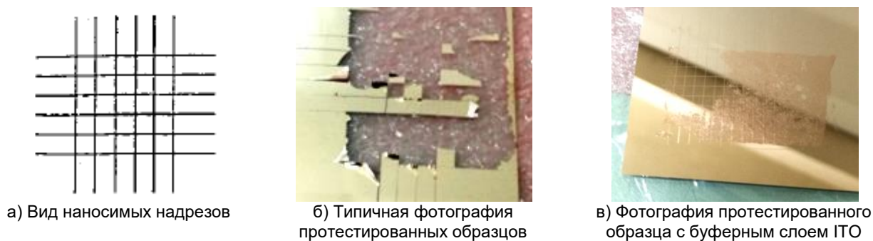
Рисунок 1 – Тестирование адгезии медной плёнки к стеклянной подложке
