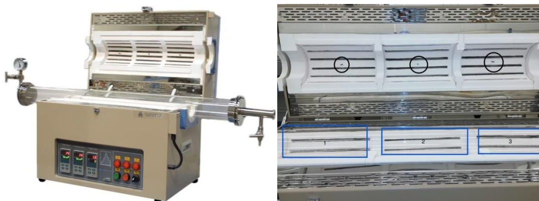
Рисунок 1 – Трехзонная трубчатая печь с кварцевой трубой, прямоугольниками обозначены зоны, кругами – термопары для измерения T_1 , T_2 и T_3
