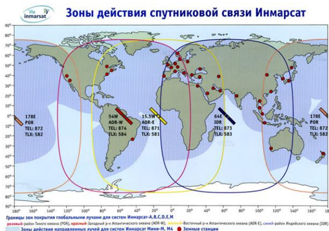
Рисунок 1 – Зона действия спутниковой связи Инмарсат
