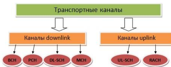
Рис.3 - Транспортные каналы на радиointерфейсе в LTE
