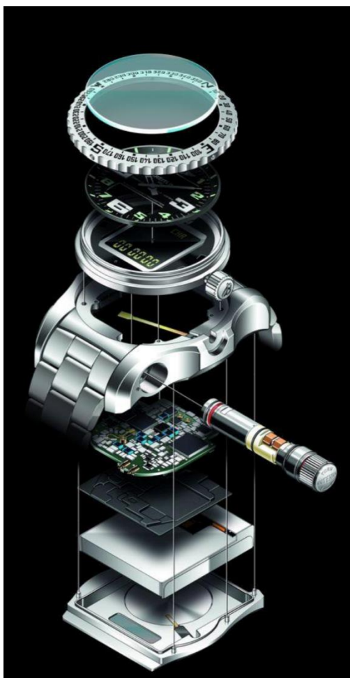
Рисунок 2 – Модель устройства со встроенным персональным радиомаяком
