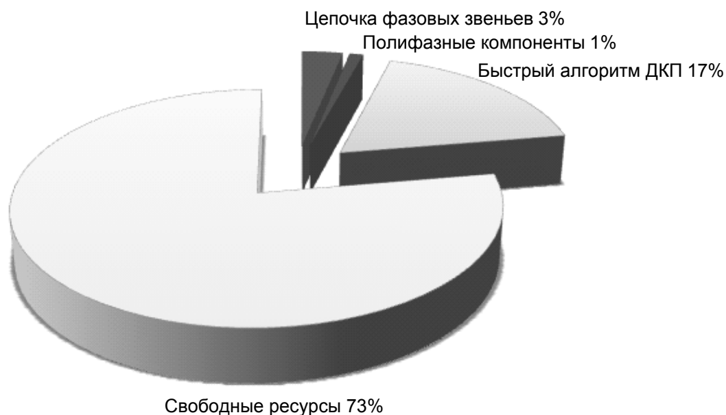
Рис. 7.21. Аппаратные ресурсы FPGA XC4VLX25 на реализацию процессора НКМБФ
