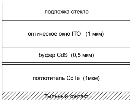
Рисунок 3.5 - Структура тонкопленочных CdTe солнечных элементов с гетеропереходом CdS/CdTe.
