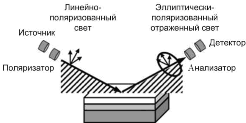
Рисунок 5.4 - Типичная эллипсометрическая конфигурация, применяемая для анализа многослойных тонкоплёночных структур
