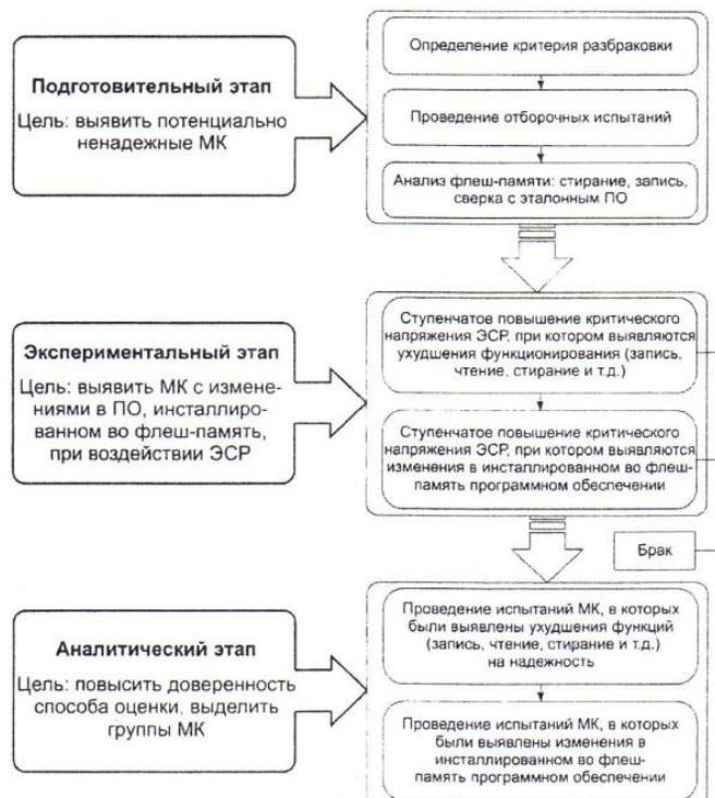
напряжения, при котором возникают изменения в программном обеспечении, инсталлированном во флеш-память этих микроконтроллеров, определяют степень повреждения массива данных флеш-памяти, проводят повторные испытания микроконтроллеров, в которых были выявлены упомянутые повреждения, и осуществляют анализ достоверности полученных результатов испытаний с формированием групп микроконтроллеров по надежности.
