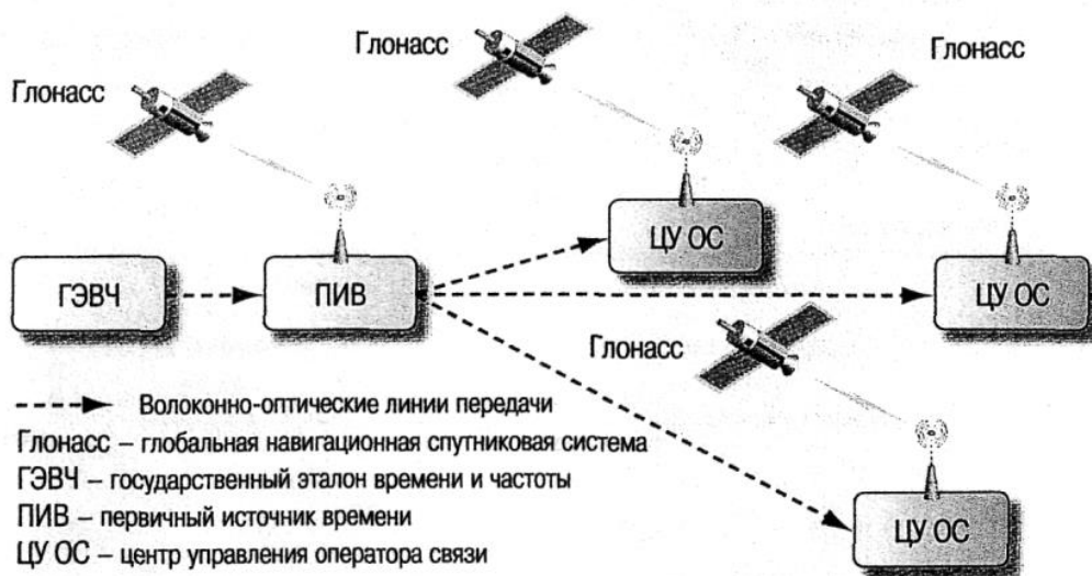
Рис.1. Структурная схема системы единого времени на сети связи общего пользования
