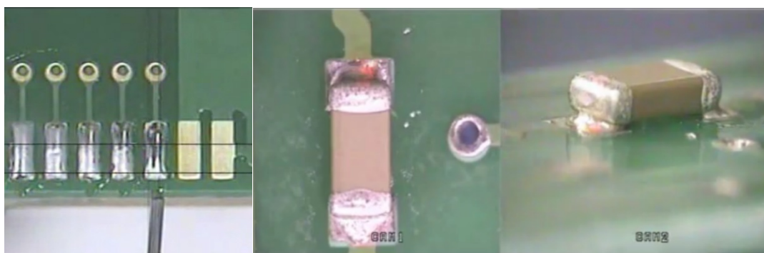
Рис.4 – Внешний вид паяных соединений, выполненных лазером
