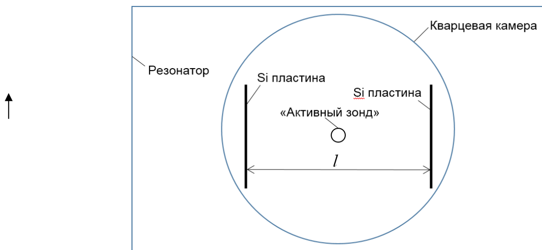
Рис. 1 - Схематичное изображение размещения пластин относительно «активного зонда» при измерении влияния расстояния между пластинами в призматическом объеме на величину СВЧ энергии между ними
