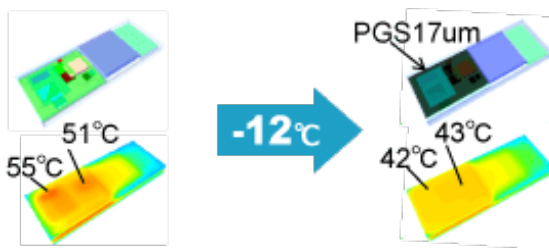
Рис. 3 - Использование PGS-пленок позволяет добиваться равномерного распределения тепла
