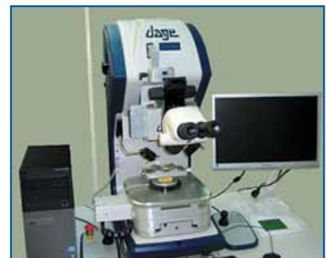
Рис. 5. Установка контроля прочности перемычек тянущим усилием сварных соединений на сдвиг
