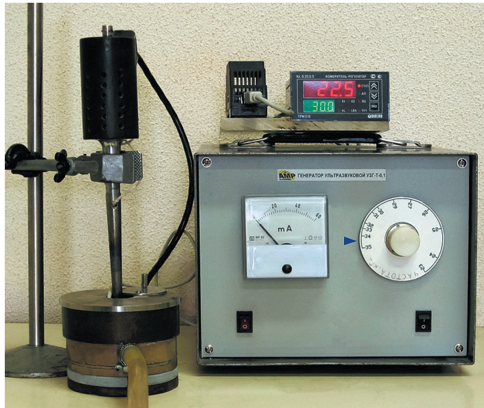
Рис. 5. УЗ-установка модификации структуры припоев
