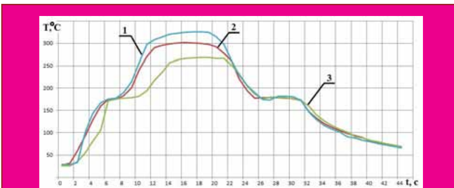
Рис. 8. Температурные профили при различном угле наклона насадки термофена относительно платы: 1 — 90°; 2 — 60°; 3 — 30°
