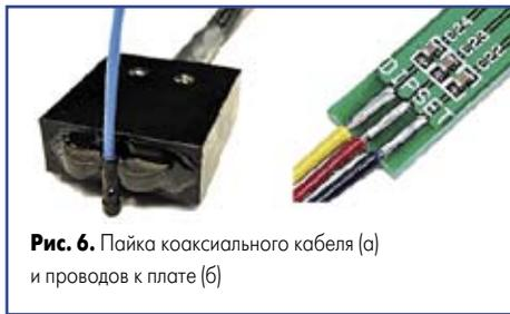
Рис. 6. Пайка коаксиального кабеля (а) и проводов к плате (б)
