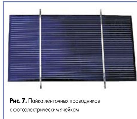
Рис. 7. Пайка ленточных проводников к фотоэлектрическим ячейкам
