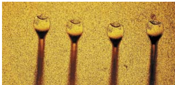
Рис. 16. Внешний вид соединений шариком на золотой проволоке диаметром 20 мкм
