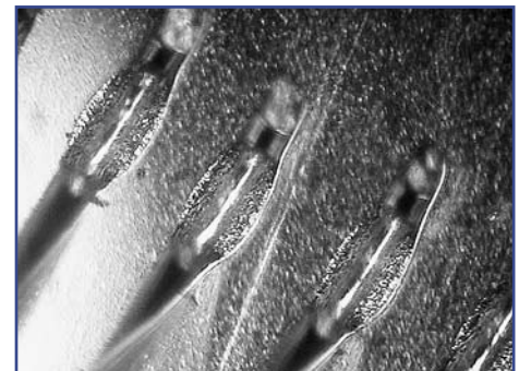
Рис. 13. Внешний вид сварных соединений алюминиевой проволокой диаметром 27 мкм
