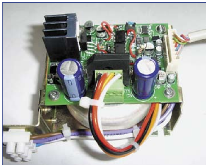
Рис. 5. Модуль управления пьезоприводом механизма зажима проволоки
