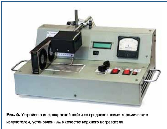
Рис. 6. Устройство инфракрасной пайки со средневолновым керамическим излучателем, установленным в качестве верхнего нагревателя
