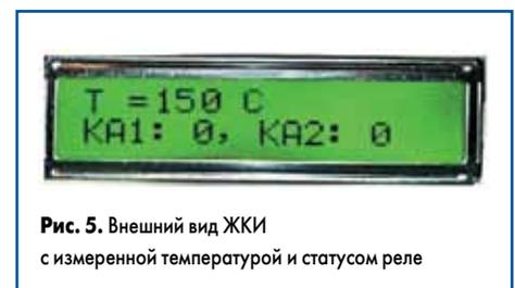
Рис. 5. Внешний вид ЖКИ с измеренной температурой и статусом реле
