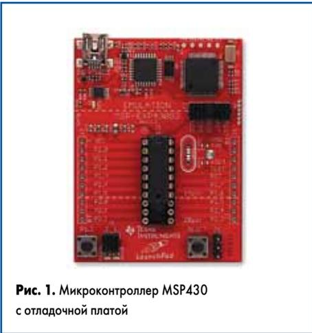
Рис. 1. Микроконтроллер MSP430 с отладочной платой
