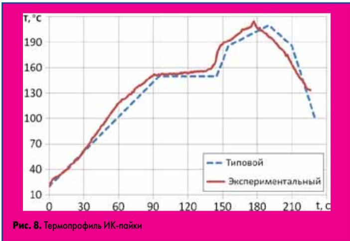
Рис. 8. Термопрофиль ИК-пайки
